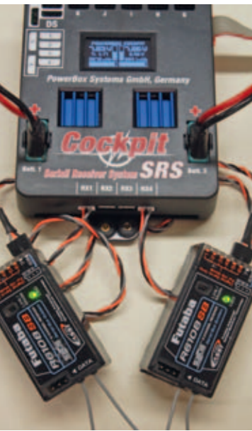
Maximale Sicherheit mit zwei Futaba R6108SB Empfängern
