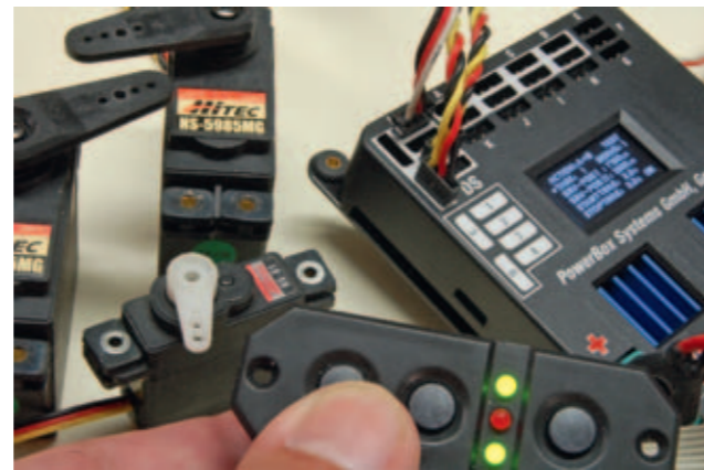
Die Einstellung der Doorsequenzer-Servos geschieht allein mit Hilfe des Sensor-Switches und der Displayanzeige
