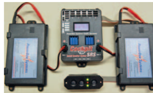
Cockpit SRS mit zwei 2s 2.800er-Stromquellen
