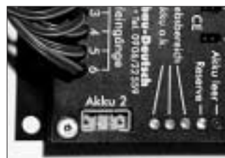
Der Akkuanschluss erfolgt über die bewährten MPX-Hochstrombuchsen.
